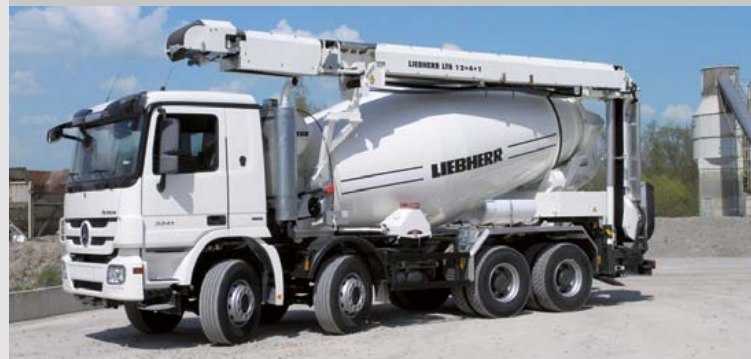
Modelo con cinta transportadora „LTB“
