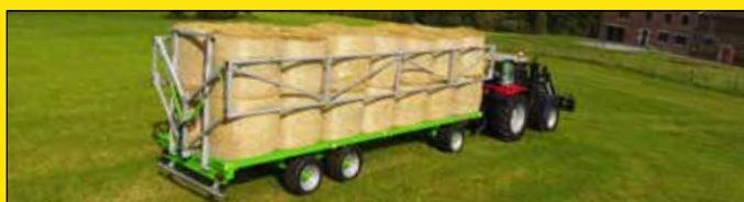
В опции модели 8000D13, 10000T15 и 10000T20 могут быть оснащены гидравлическими боковыми барьерами (2 ОД), увеличивающими безопасность использования и скорость операций
