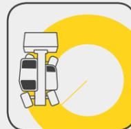
**Kleiner Wendekreis, große Leistung.** Alle Wacker Neuson Teleskopklader verfügen über besonders kleine Innenradien ab 595 mm – ideal, um sie vielfältig und nahezu überall einzusetzen.
