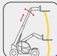
**Arbeiten Sie so sicher wie nie.** Das innovative Fahrerassistenzsystem VLS (Vertical Lift System) schaltet sich z.B. bei Überlastgefahr teilautomatisiert und intelligent in die Teleskopierbewegung ein und senkt den Teleskoparm ab bzw. fährt ihn ein, ohne die Arbeit zu unterbrechen. Das verschafft Sicherheit und Komfort bei gleichzeitiger Effizienz.
