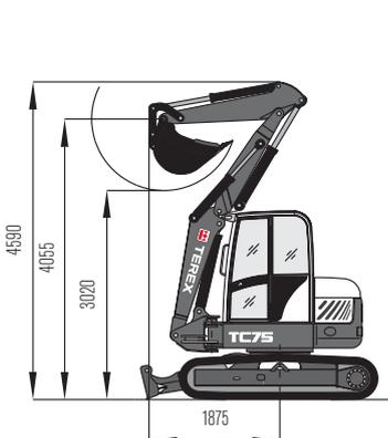
Fig. 2: Pluma “Circular” - altura útil
