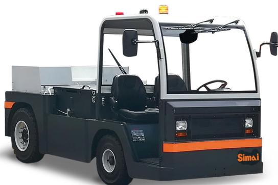
Tractor de 4 ruedas, con dispositivo "hombre presente". Posee tracción trasera para remolcar cargas pesadas. Potencia y autonomía: sumamente elevadas. Amplia plataforma trasera con capacidad de carga de 200 kg.
