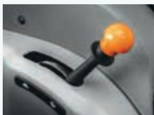
Leva di innesto del superri- duttore in posizione ergonomica e facilmente a portata di mano.
