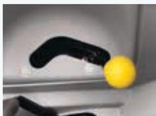
Sui modelli con cabina e trasmissione Synchro Shuttle™, l'inserimento della PdP è comandato da una leva servoassistita in posizione ergonomica per un azionamento senza sforzo.
