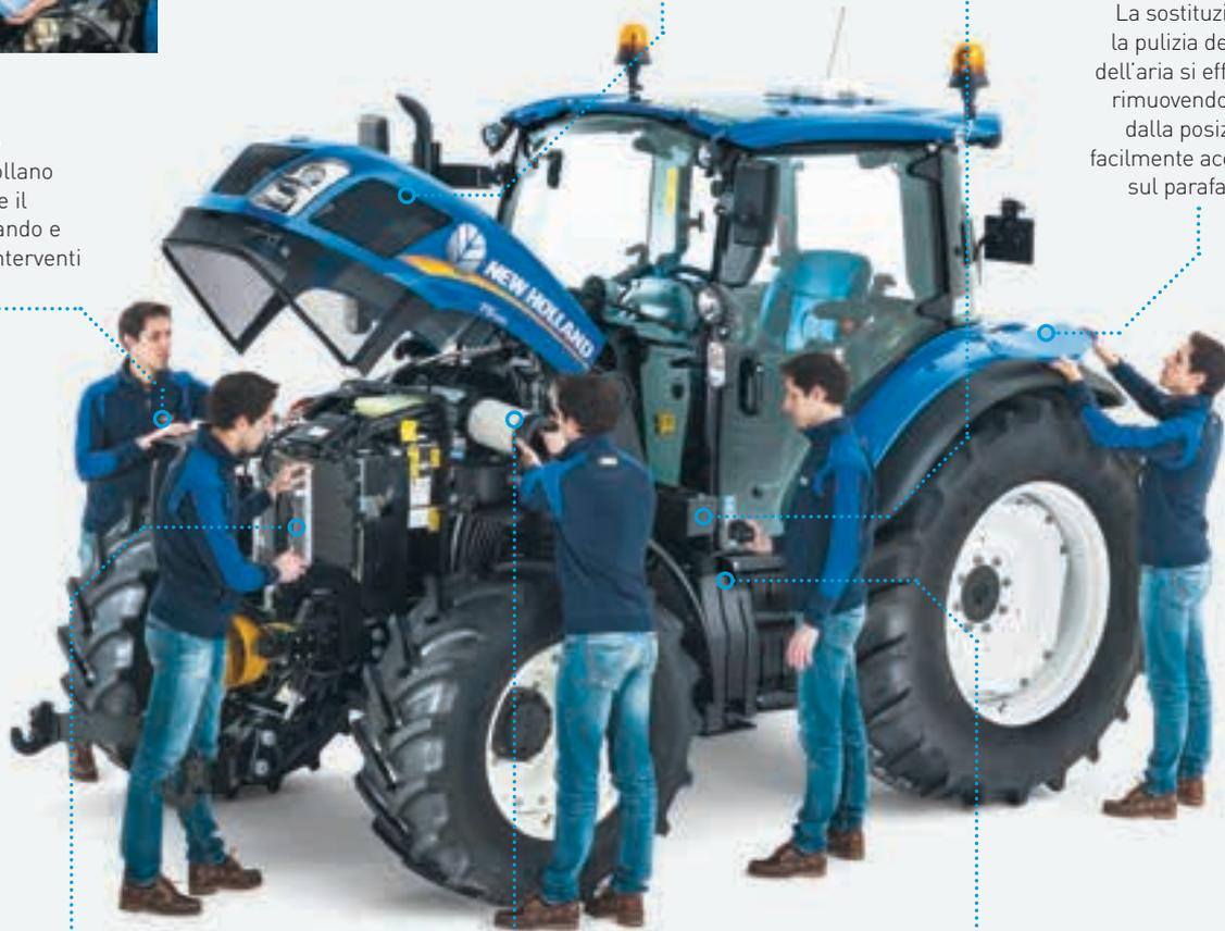
Il modulo di raffreddamento si estrae tramite una guida scorrevole e può essere pulito in modo rapido e semplice.
