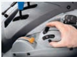
Leva principale del cambio e innesto del freno di stazionamento in posizione ergonomica.
