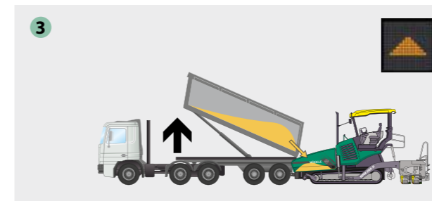
3 Ribaltare il cassone: il camionista deve ribaltare il cassone per scaricarne il contenuto.
