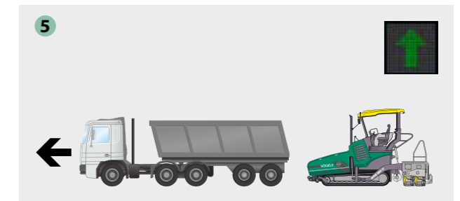
5 Allontanamento: il camion deve allontanarsi dalla finitrice.
