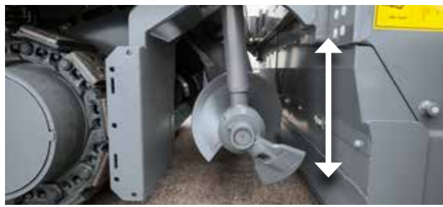
3 Sollevamento / abbassamento della coclea distributrice
