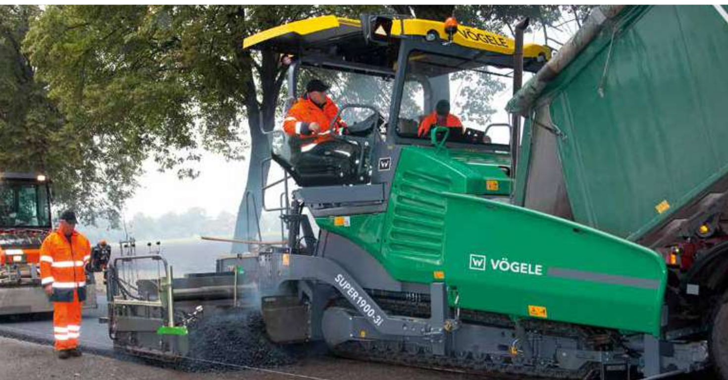
Die Antriebsstation des SUPER 1900-3i erfüllt mit einem Dieselpartikelfilter (DPF), einem Dieseloxydationskatalysator (DOC) und selektiver katalytischer Reduktion (SCR) zur Abgasnachbehandlung die strengen Richtlinien der europäischen Abgasstufe V und der US-Norm EPA Tier 4f.
