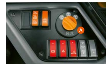
Sélecteur rotatif (A) pour la sélection du mode de direction sur le SCORPION VARIPOWER.
