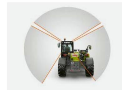
Vision dégagée vers l'arrière assurant un surcroît de sécurité, grâce à l'ancrage surbaissé du bras télescopique.
