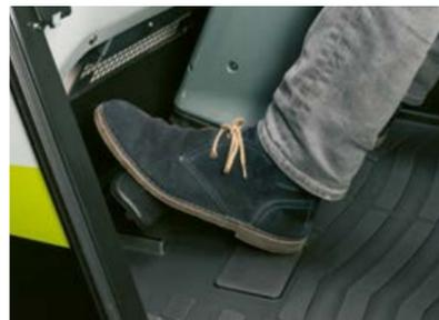
La pédale de frein à fonction d'approche limite la consommation de carburant et l'usure des freins.
