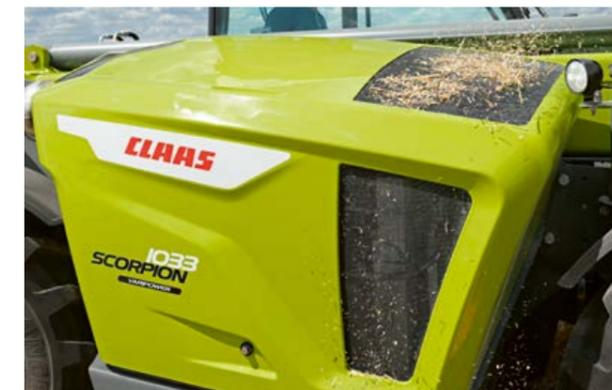
Encrassement minimal du radiateur grâce au ventilateur réversible.
