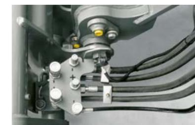
Raccords hydrauliques sécurisés sur le tablier.
