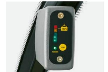
Feu tricolore pour l'indicateur de charge : en cas de dépassement de la limite de stabilité, toutes les diodes s'allument et un signal sonore retentit.
