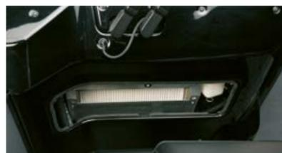
Accès aisé au filtre à air de la cabine.
