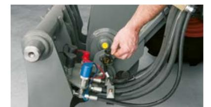
Prises permettant une alimentation électrique adaptée pour différents outils frontaux et attelés.
