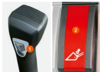
Changement d'outil simple et sûr grâce à deux interrupteurs (1 et 2).
