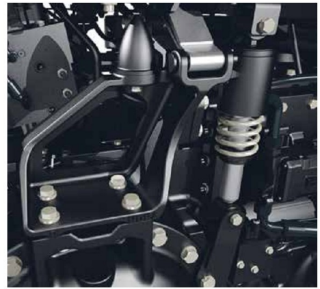
La cabine suspendue vous offre un transport plus doux que ce soit sur route ou sur terrain accidenté.
