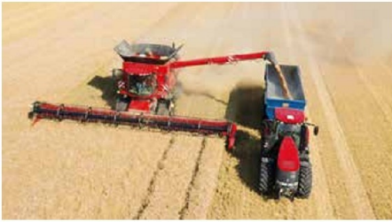
AFS AccuGuide™ : un guidage basé sur les systèmes GPS et GLONASS pour une précision de dernière génération, indépendante des conditions de culture. Des niveaux de précision disponibles en dessous de 2,5 cm.
