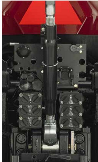
Pas de limites d'utilisation avec les 6 distributeurs électro hydrauliques à l'arrière.
