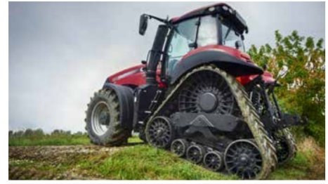
Les roues et les chenilles restent en contact avec le sol pour une traction maximale.
