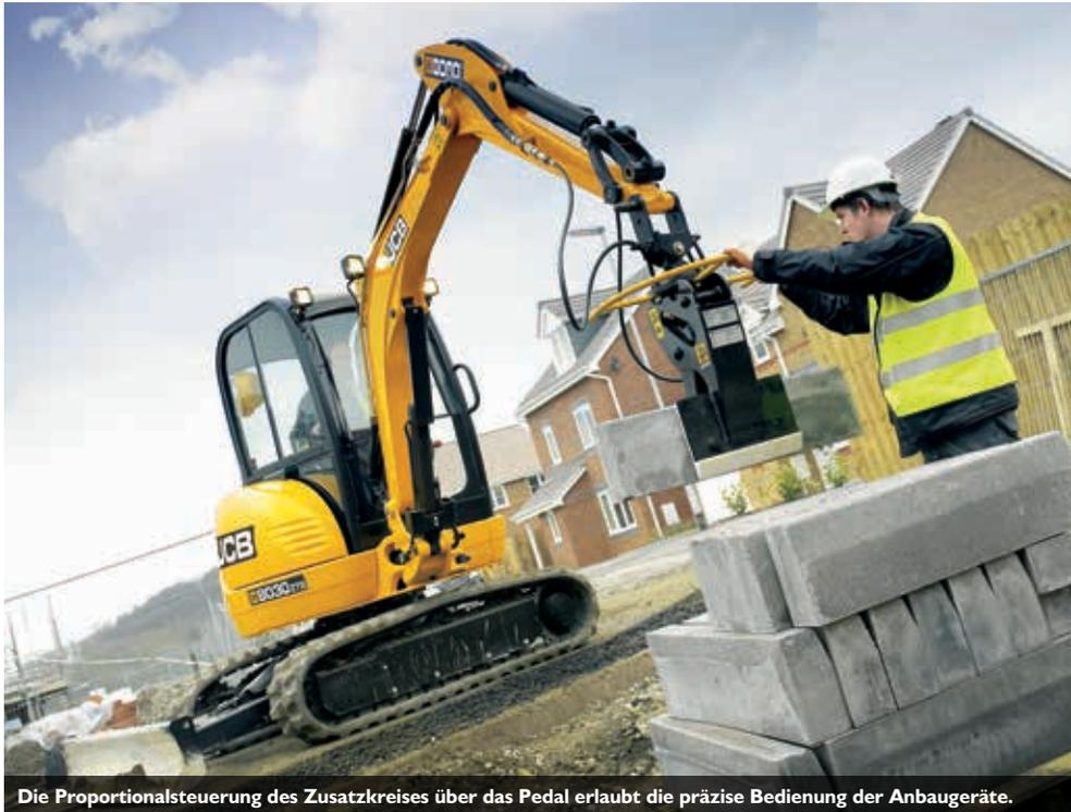
Die Proportionalsteuerung des Zusatzkreises über das Pedal erlaubt die präzise Bedienung der Anbaugeräte.
