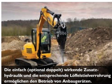
Die einfach (optional doppelt) wirkende Zusatzhydraulik und die entsprechende Löffelstielverrohrung ermöglichen den Betrieb von Anbaugeräten.
