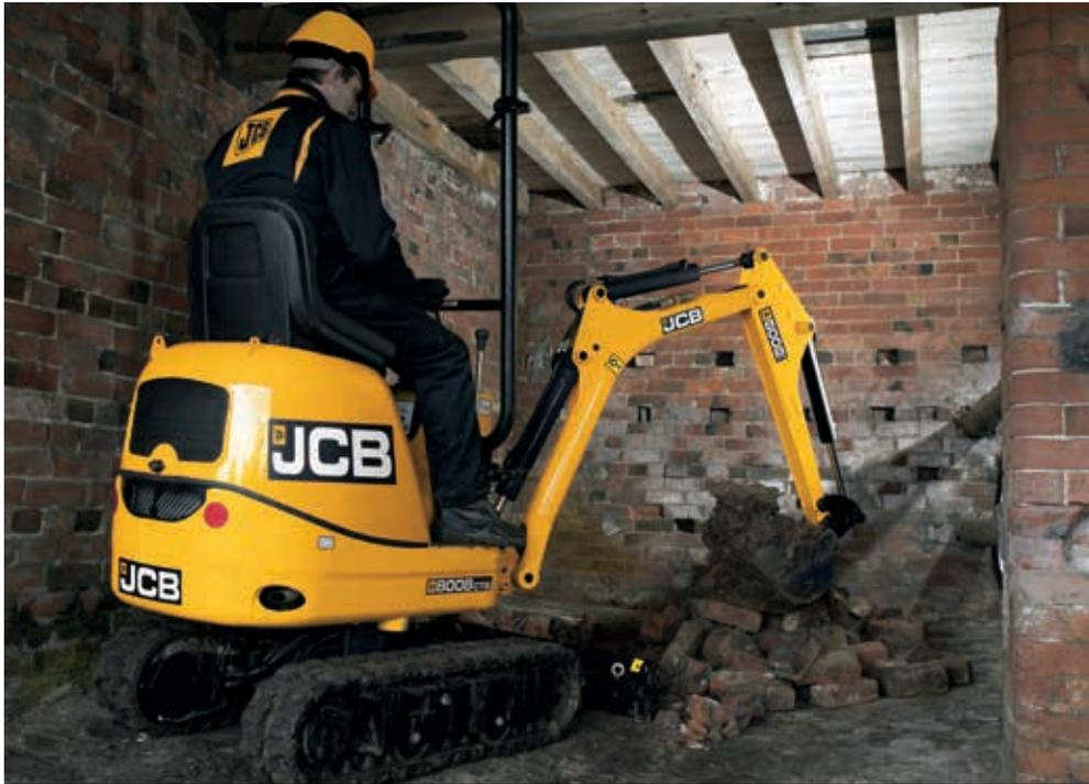
Kompakte Größe und minimaler Hecküberstand ermöglichen den Einsatz auf engstem Raum.
