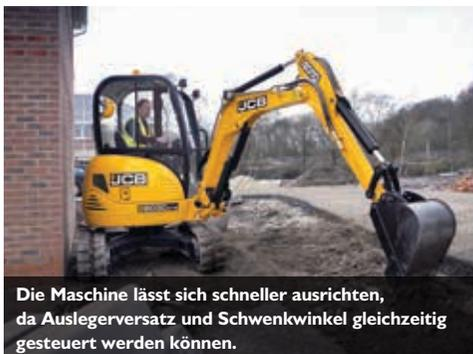
Die Maschine lässt sich schneller ausrichten, da Auslegerversatz und Schwenkwinkel gleichzeitig gesteuert werden können.
