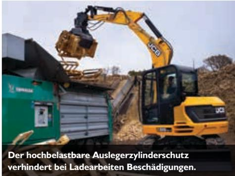
Der hochbelastbare Auslegerzylinderschutz verhindert bei Ladearbeiten Beschädigungen.
