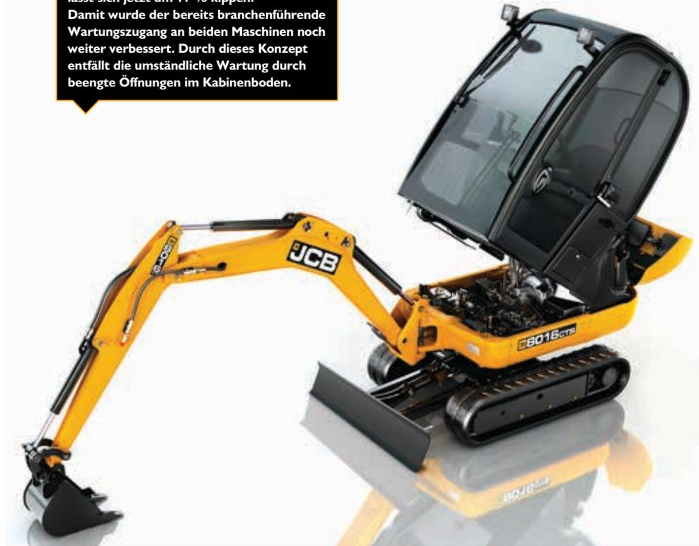
Die gasdruckfederbetätigte Heckabdeckung lässt sich weit öffnen und bietet so bequemen Zugang für Routinekontrollen.
