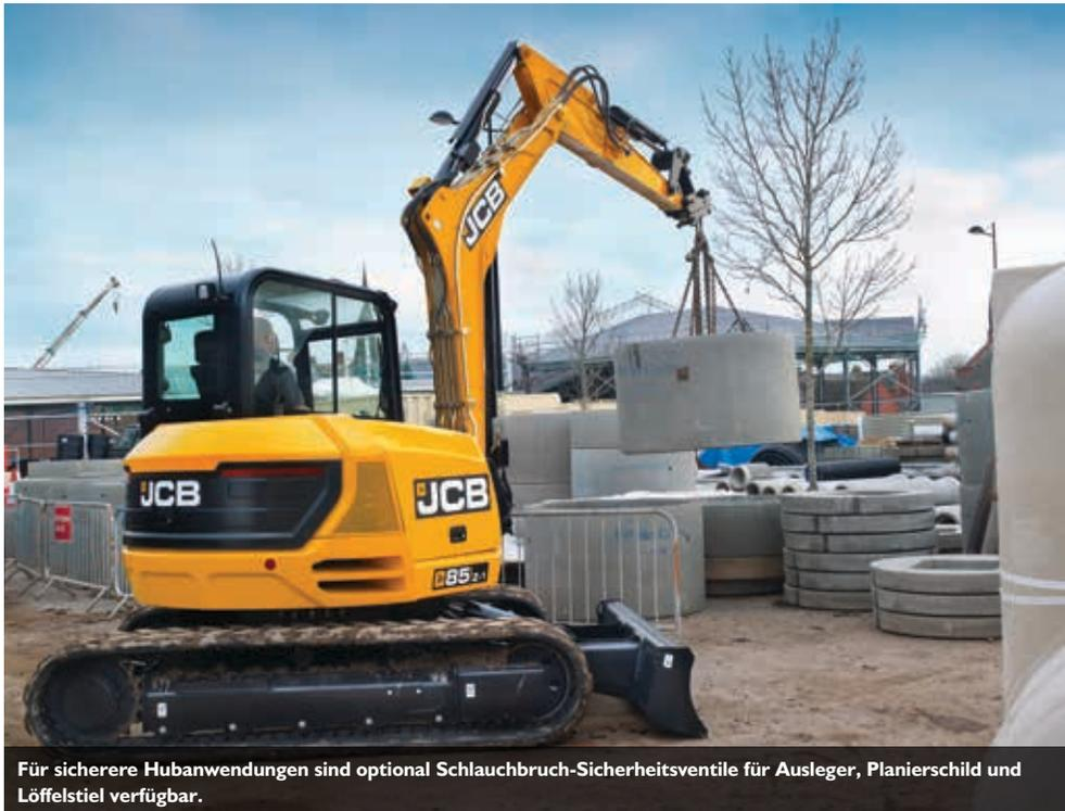
Für sicherere Hubanwendungen sind optional Schlauchbruch-Sicherheitsventile für Ausleger, Planierschild und Löffelstiel verfügbar.
