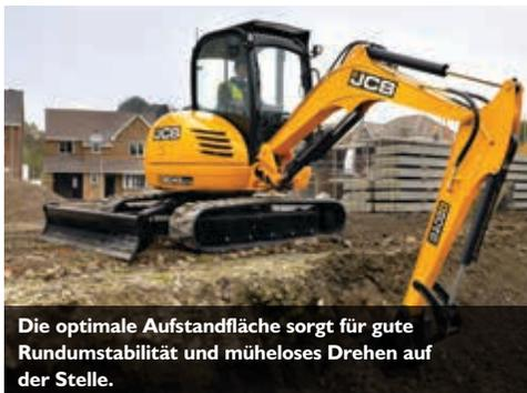
Die optimale Aufstandfläche sorgt für gute Rundumstabilität und müheloses Drehen auf der Stelle.
