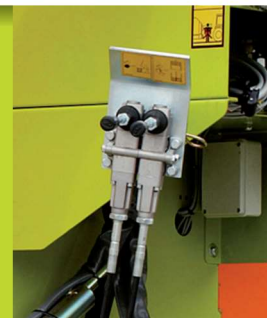
Comandi meccanici flessibili a distanza (standard per Husky MT)
