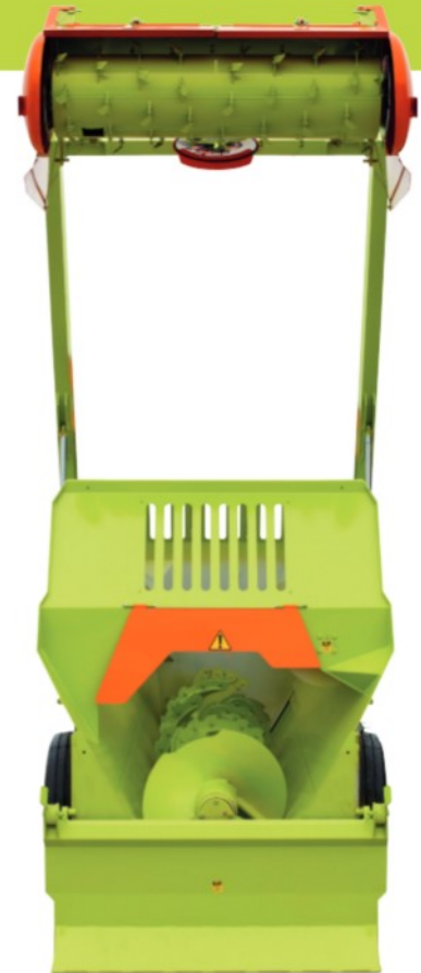
Dispositif automatique d'accrochage du racleur pour la protection de la fraise de désilage pendant la circulation sur un terrain accidenté
