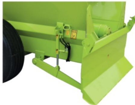
Dispositif automatique d'accrochage du racleur pour la protection de la fraise de désilage pendant la circulation sur un terrain accidenté
