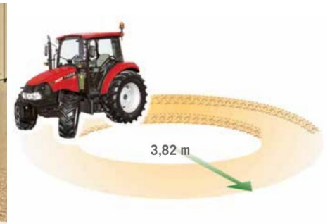
Promień skrętu 3,82 m (Farmall 55 C – 75 C) i 4,33 m (Farmall 85C–115 C).
