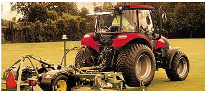
Nieagresywna rzeźba bieżnika opon do prac wykonywanych na delikatnej darni pól sportowych.
