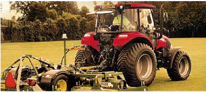
Forme de la bande de roulement du pneu non agressive adaptée à l'utilisation sur terrains de sport.
