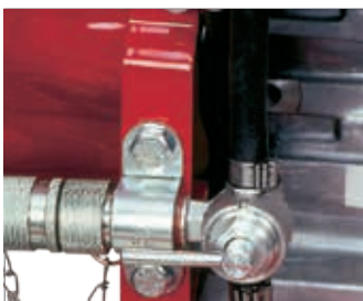
3-Wege Kraftstoffhahn Zum direkten Anschluss eines Betankungssystem.
