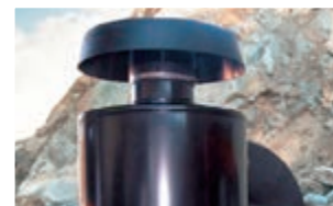
Oljebehandlat luftfilter Ökar rengöringseffekten i luftintaget i extremt dammiga områden som i stenbrott.
