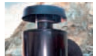
Filtro de aire lavado con aceite Aumenta la limpieza de la toma de aire en áreas muy polvorrientas, como las canteras.
