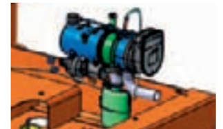
Calentador diésel Mejora la capacidad de arranque en condiciones de frío extremo calentando el refrigerante y el combustible.
