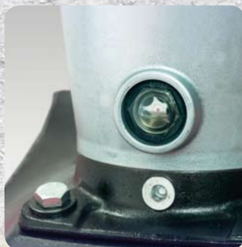
Sistema de apiloamento com controlos do nível do óleo
