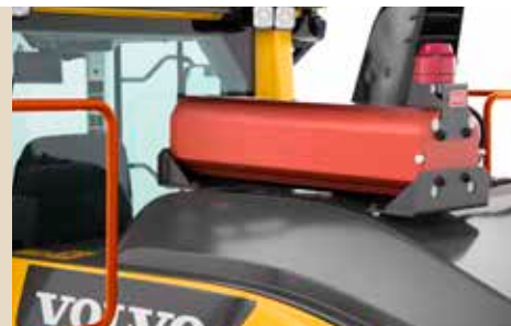
Système de protection contre l'incendie
