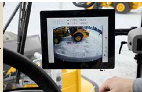
Système de détection radar
