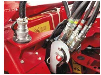
Montez la barre de coupe en un clin d'œil avec le multi-coupleur qui relie tous les circuits hydrauliques.
