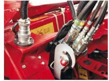
Monte el cabezal en cuestión de minutos utilizando el cierre único que conecta todos los servicios hidráulicos
