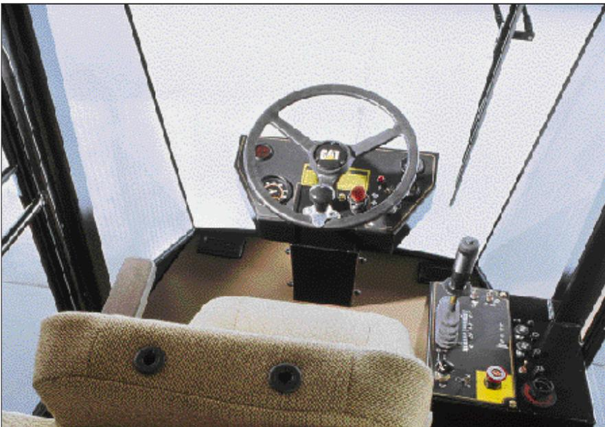
**Ergonomische Gestaltung.** Mit dem griffgünstigen Fahrhebel lassen sich Geschwindigkeit und Fahrtrichtung leicht und feinfühlig steuern. Der Ein-Aus-Schalter des Vibrationssystems auf dem Fahrhebel ermöglicht eine praxisgerechte Einhand-Bedienung. Auf Wunsch ist eine gut ablesbare Frequenzanzeige erhältlich, die sich im direkten Sichtfeld des Fahrers auf der Lenksäulenkonsole befindet. Große Fenster und die abgeschrägte Motorhaube verbessern die Sicht nach allen Seiten.
