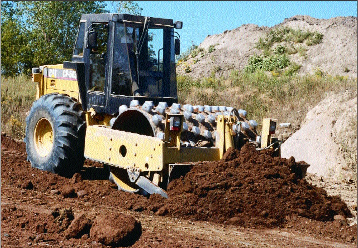
**Exzellenter Vortrieb.** Die Walzenzüge der Serie 563C haben sich in schwierigsten Bodenverhältnissen hervorragend bewährt. Dafür gibt es mehrere entscheidende Gründe, wie zum Beispiel optimale Gewichtsverteilung, günstiges Leistungsgewicht, hydrostatischer Bandagen- und Hinterradantrieb.
