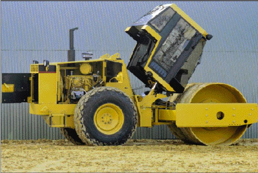
**Einfache Überprüfung.** Alle Kreise der Hydraulik werden serienmäßig mit Meßanschlüssen versehen, die in Gruppen zusammengefaßt sind und rasche Druckmessungen ermöglichen.
