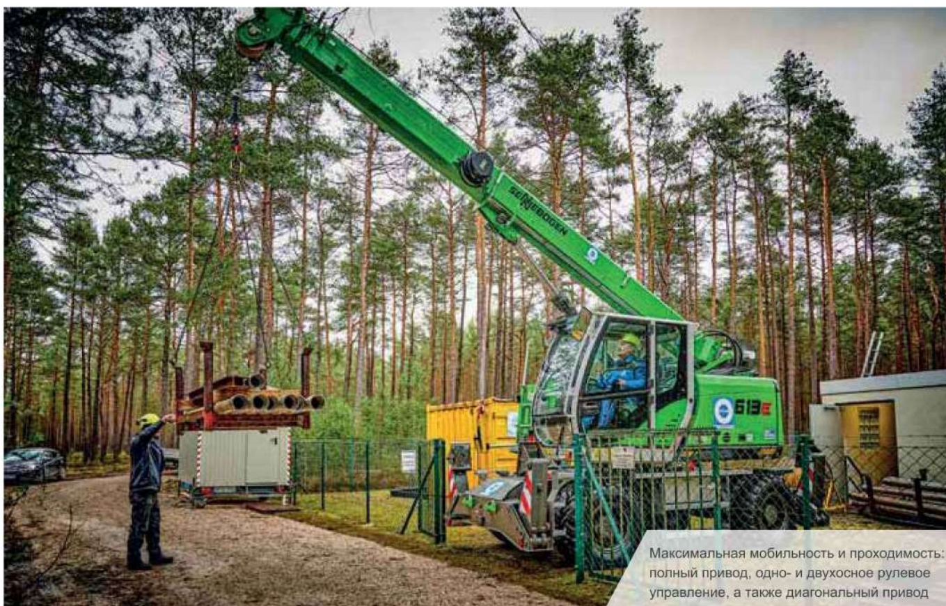
Высокая устойчивость благодаря соразмерному соотношению длины и ширины опорной площадки (4 м x 4,35 м)
