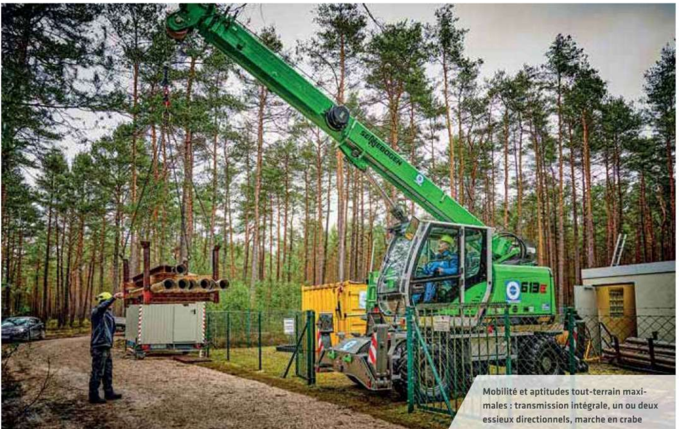
Stabilité optimale pour une surface d'appui au sol réduite de 4 m x 4,35 m
